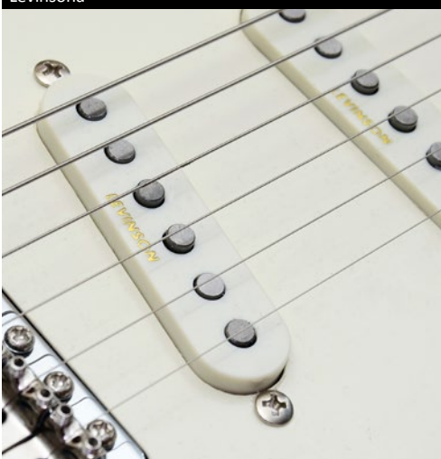
W układzie elektrycznym zamontowano 3 single VS-1 Levinsona
